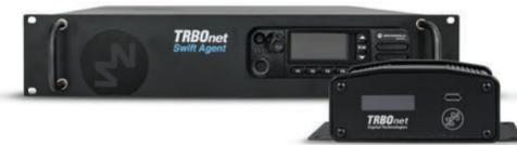
Радио-IP шлюз работает в связке с контрольной (донорской) радиостанцией и подключается к диспетчерскому ПО TRBOnet по IP, что позволяет диспетчеру работать с радиоканалом. Радио-IP шлюз поддерживает радиостанции DM серии 4000, работающие в цифровом или аналоговом режиме. Также для голосовых вызовов поддерживаются разнообразные аналоговые и цифровые радиостанции HE-MOTOTRBO.
